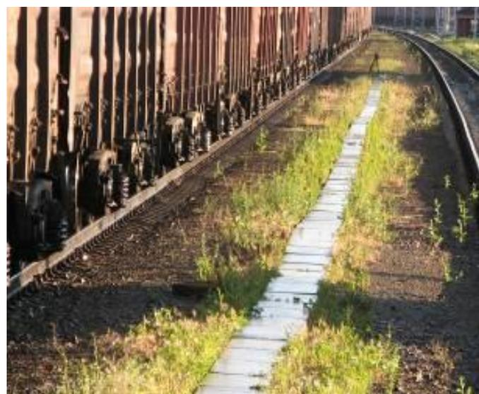
**Фото 1 –Состояние путей и междупутий перед химической обработкой
